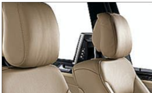
Opěrky hlavy NECK-PRO vpředu snižují riziko nárazového šoku (komfortní výbava k dodání za příplatek).
