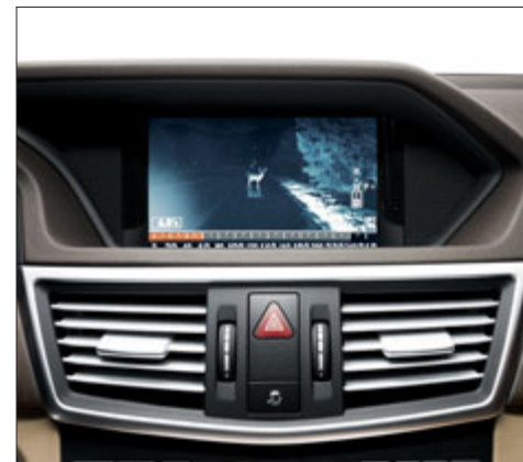
Asistent nočního vidění Plus Vám zobrazí na centrálním displeji prostor jako obrázek, kam až dosahují dálková světla.
