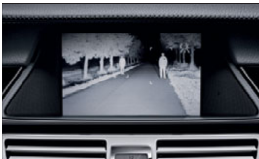
Asistent nočního vidění Plus Vám znázorní prostor, kam až dosahují dálková světla, jako obrázek na centrálním displeji.
