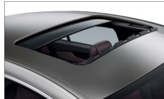
Posuvné střešní okno s funkcí otevírání dálkovým ovládáním.
