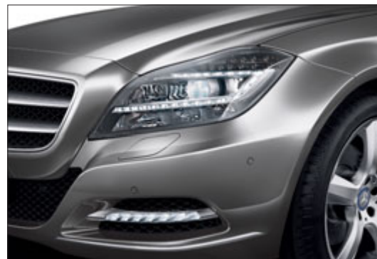
Světlomety s integrovaným infračerveným modulem LED.
