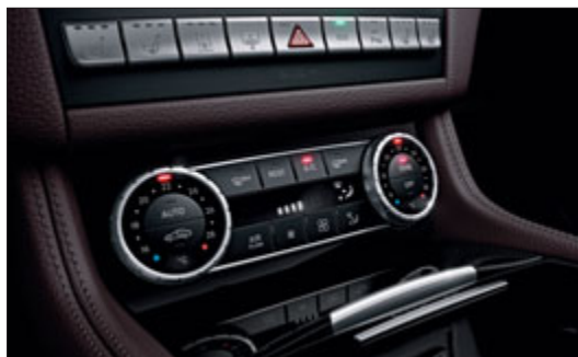
Pomocí automatické klimatizace THERMOTRONIC lze regulovat teplotu ve třech individuálních zónách.
