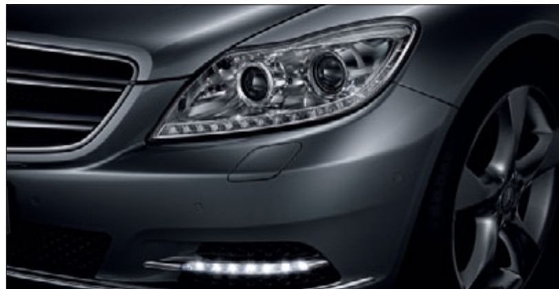
Bi-xenonové světlomety s inteligentním systémem světel a denní osvětlení LED v nárazníku.
