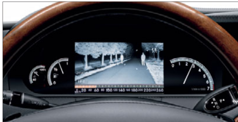
Díky infračervenému světlu je asistent nočního vidění Plus schopen rozpoznat chodce až ve vzdálenosti 90 metrů.
